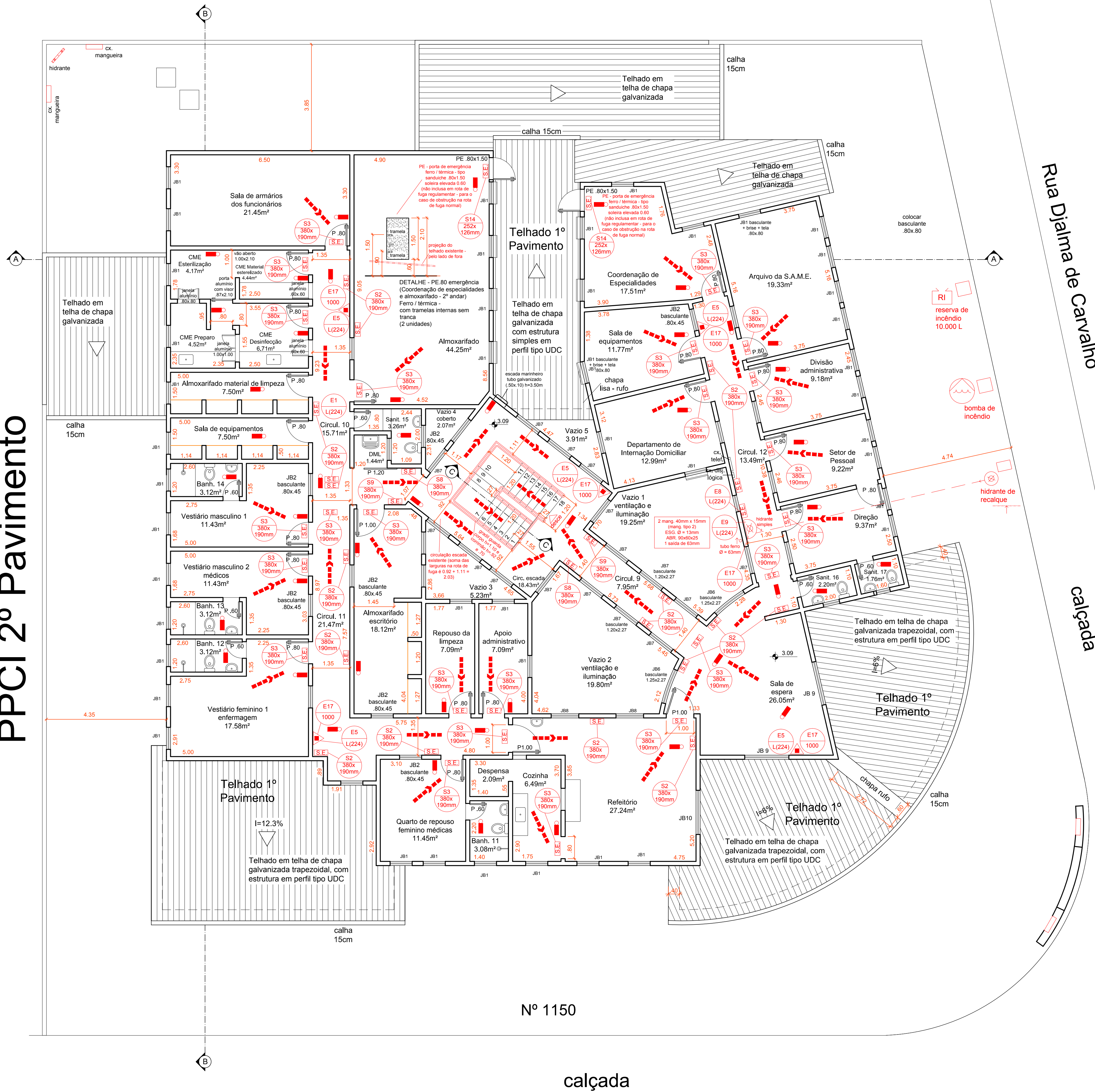
Planta Baixa 2º Pavimento - (Área interna = 489.91m²) escala 1:75
