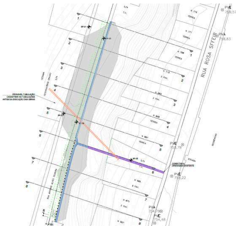
Figura 3-Planta de localização da cortina atirantada
