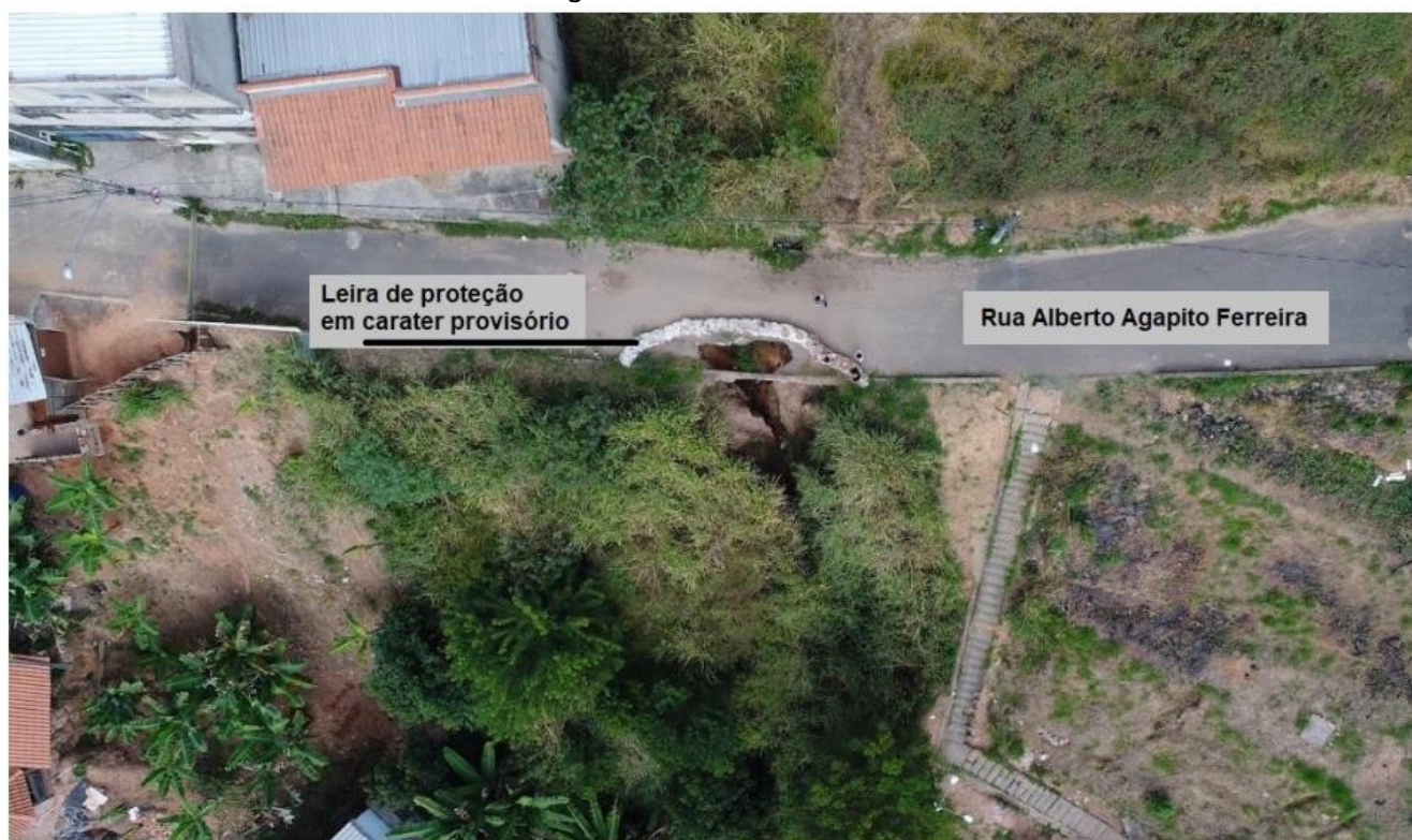
Figura 1: Erosão no talude
