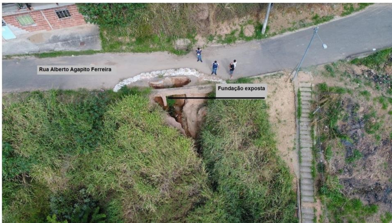
Figura 2: Área afetada antes da ruptura
