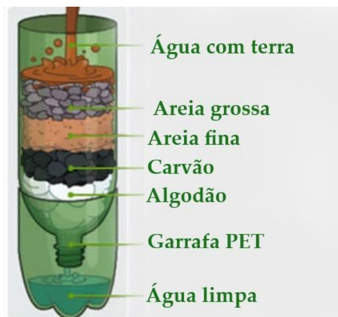
Figura 83: Esquema de montagem do filtro de água caseiro.
